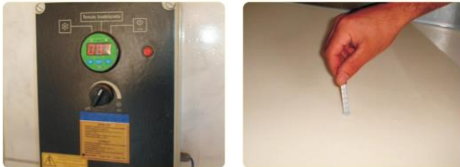
Figura 3. Medição da temperatura do leite, onde o transportador deve possuir um termômetro tipo “espeto” para a verificação da temperatura do leite, em caso do leitor do resfriador estiver avariado ou não estiver funcionando.
