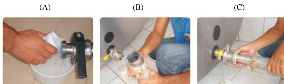
Figura 5. Higienização das conexões pelo transportador (A-C).
