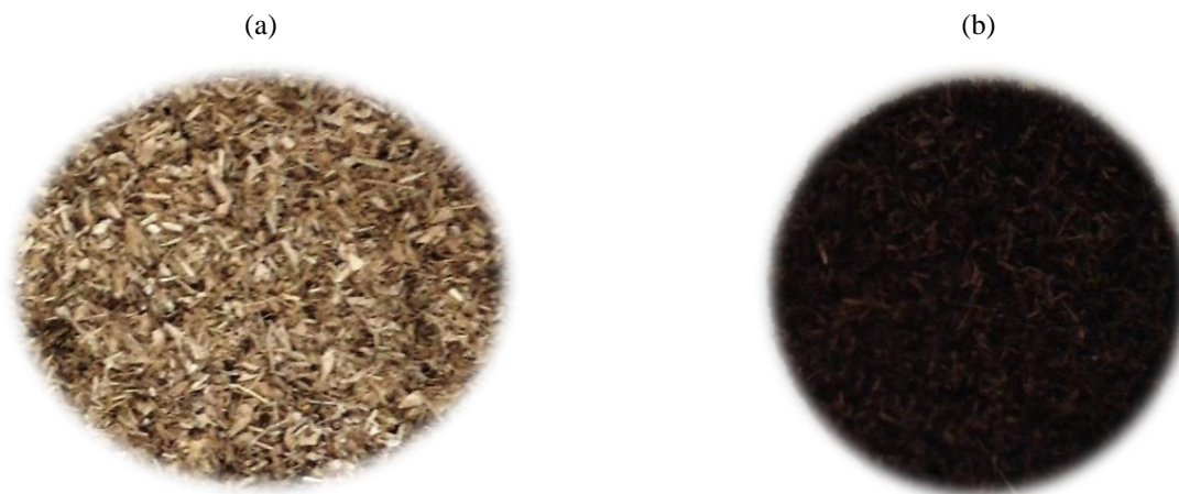
Figura 1. Palha de soja 2013/2014 moída (a) sem e (b) com fermentação com Aspergillus niger
