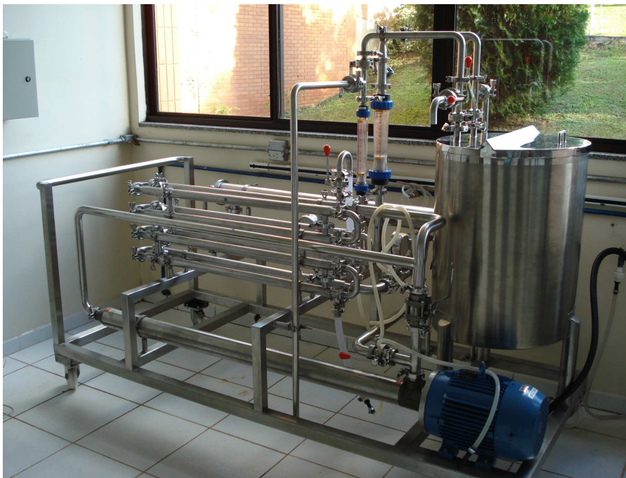
Figura 1 Módulo de Osmose Inversa
