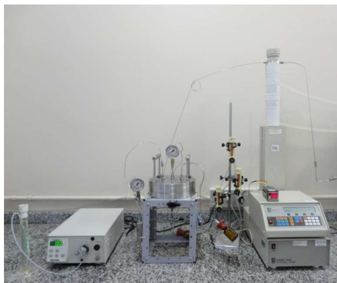
Figura 2. Vista geral da unidade de separação com membranas
