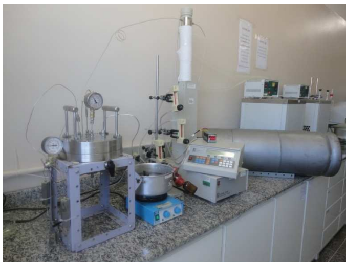
Figura 3. Vista geral da unidade de separação com membrana com gás GLP.
