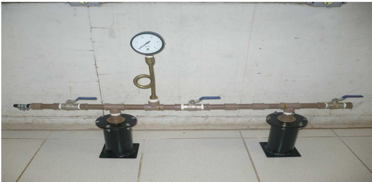
Figura 3: Protótipo de picnômetro a ar.
