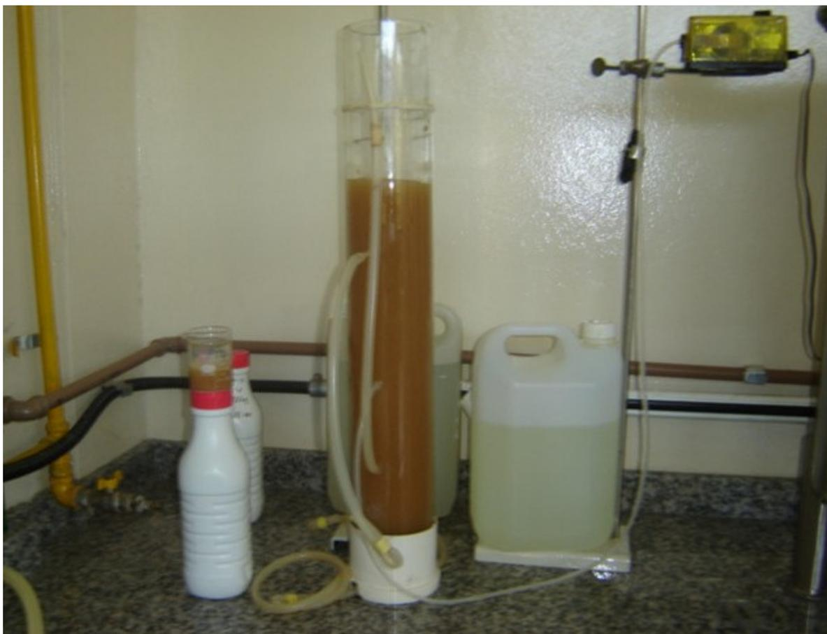
Figura 2: Reator em batelada seqüencial tratando efluente da indústria de balas.
