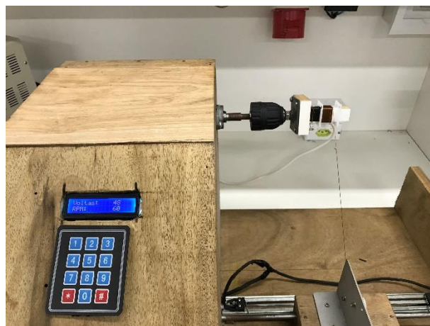
Figura 4 – Processo de bobinamento
