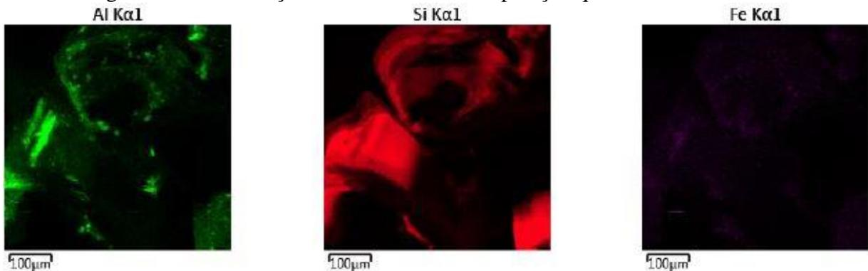
Nas Figuras 31 e 32 não se observa cromo na amostra visualmente, isso ocorre pois a partir dos resultados encontrados na segunda fase da dissertação, os corpos de prova alimentados com água, possuem baixa retenção do contaminante inserido no meio como já apresentado na Amostra 2, além disso, a concentração de cromo no solo do corpo de prova encontrada a partir de digestão alcalina foi baixa (1,01 mg/kg). Nessas amostras não existe presença de cálcio pois são alimentadas com água.
