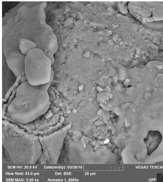
As Figuras 18 a 20 apresentaram os resultados de imagem de MEV para a amostra CONT/ALIM 7D. A partir delas podemos observar formação de uma crosta ao redor da partícula de areia que pode ser atribuída a formação de carbonato de cálcio precipitado no
