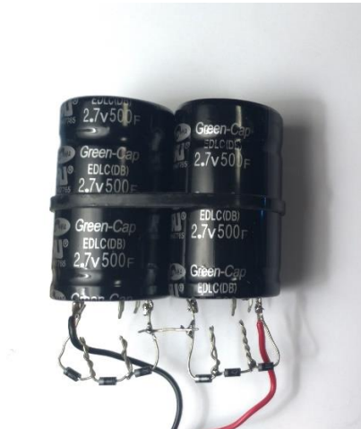
Figura 2 – Supercapacitores ligados para suportar até 5,4 V. Fonte: Produzido pelo autor.
