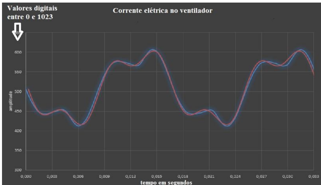
Figura 3: Forma de onda da corrente elétrica de um ventilador residencial de mesa, obtido pelo circuito eletrônico da Figura 2, mostrando que o circuito indutivo do motor do ventilador faz com que a forma de onda não seja uma senóide perfeita.
