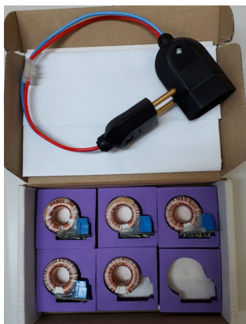
Figura 6: Vista interna da caixa Ela permite a boa acomodação de até seis sensores de corrente.
