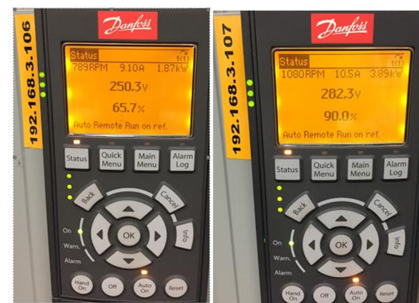
Figura 3 - Inversor de frequência à direita ( com modificação no programa, Inversor de frequência à esquerda (sem modificação do programa) Fonte: elaboração do autor (2018)
