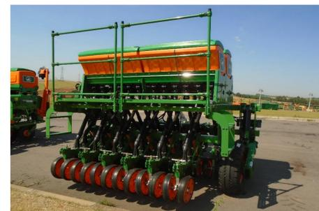
Figura 11: Plantadeira Agrícola com corrimão a partir de fixador fundido
