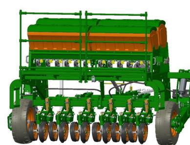
Figura 10: Projeto Plantadeira Agrícola com corrimão a partir de fixador fundido.
