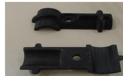
Figura 7: Fixador impresso
