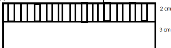
Imagem 03 – Desenho da estrutura para fazer o cano de chaminé.
