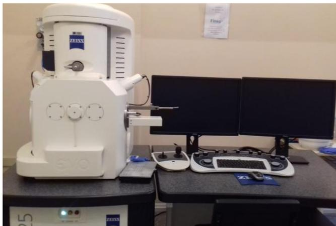
Figura 02: Microscópio Zeiss (EVO LS25), equipamento utilizado para realização das análises de MEV. Fonte: autores.
