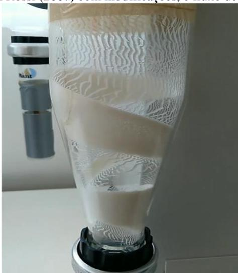
Figura 01: Obtenção de hidrolisado seco com maltodextrina através de *spray dryer* em temperatura de 160°C. Fonte: autores.
