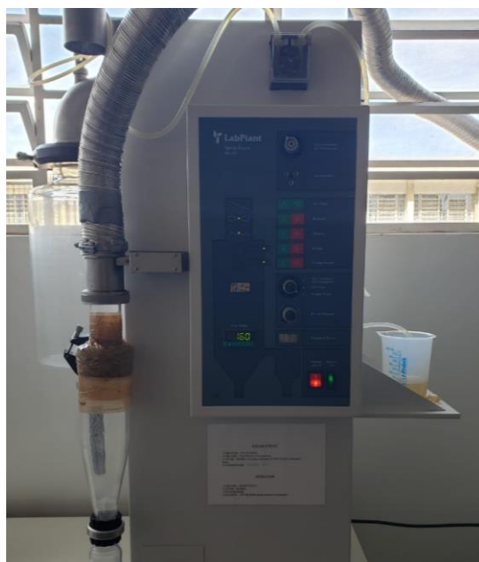
Figura 1: secagem de hidrolisado através de spray dryer em temperatura de 160°C. Fonte: O autor.
