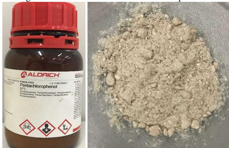
Com as amostras de solo e a solução padrão preparadas, iniciou-se o processo de contaminação considerando uma massa de 100g de solo em massa seca. Para a contaminação, foi retirada uma alíquota de 10 ml da solução padrão (ou solução estoque), a qual foi diluída em 50 ml de hexano, para completa solubilização (Figura 31).
