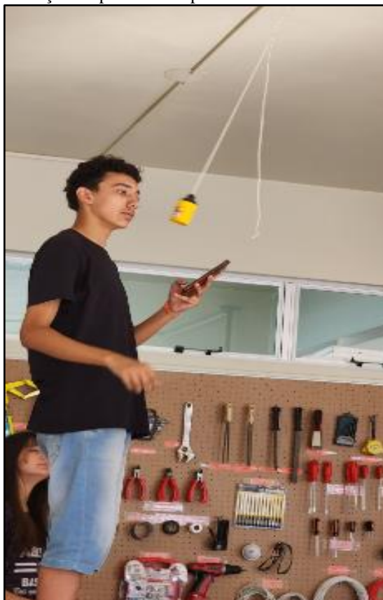
Figura 14 - Grupo de alunos medindo o período de oscilação do pêndulo simples
