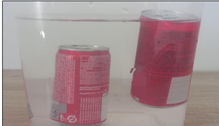
Figura 5 - “Densidade das latas de refrigerantes”
