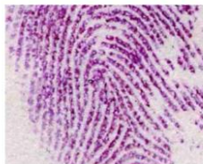
Figura 9 – púrpura de Ruhemann produzido pela reação com ninidrina. ( https://www.criminalistica.mx/areas-forenses/dactiloscopia/1632-reactivos-quimicos-para-rastros-latentes )
