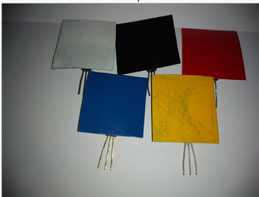
Figura 03: Sensores LM35 com placas coloridas para aferição do processo de Transmissão de Calor por Irradiação
