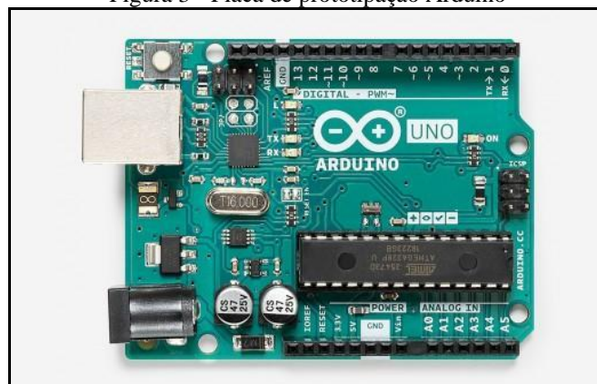
Figura 3 - Placa de prototipação Arduino
