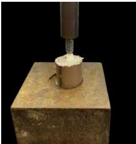
Figura 15: Teste de resistência à fratura em máquina de ensaios universais.
