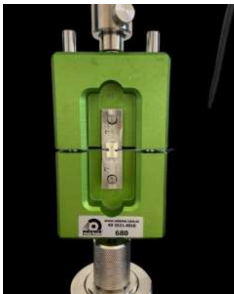
Figura 17: Teste de Resistência Coesiva em máquina de ensaios universais EMIC.
