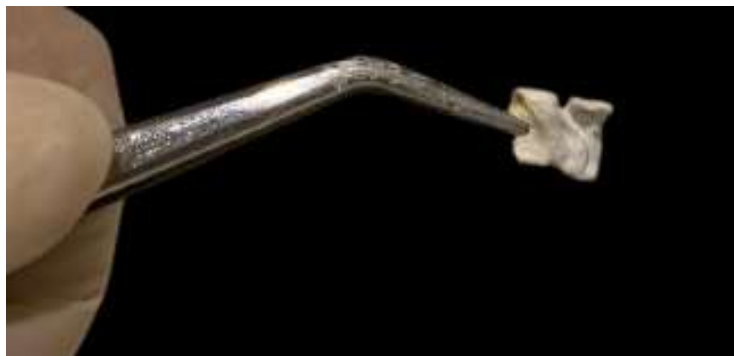
Figura 18: Endurecimento da pasta de óxido de zinco e eugenol em amostra de teste de resistência coesiva, após 21 dias de imersão.
