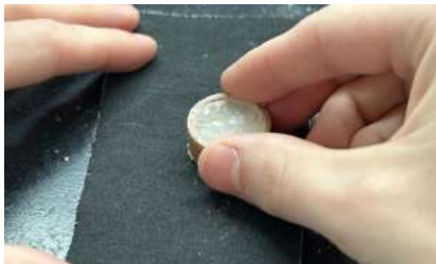
Figura 5: Amostras sendo lixadas com lixas abrasivas.
