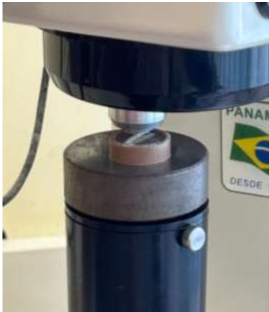
Figura 8: Teste de Microdureza em microdurômetro Vickers
