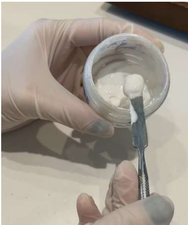
Figura 19: Pasta Experimental com características físicas estáveis após 297 dias de manipulação.
