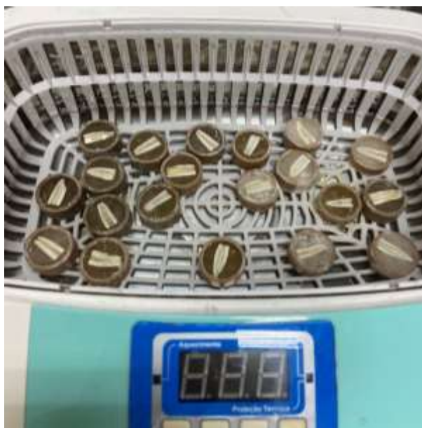
Figura 6: Lavagem das amostras em cuba ultrassônica.
