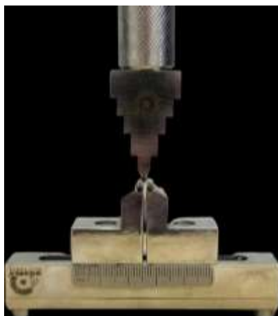
Figura 12: Teste de resistência flexural, utilizando um dispositivo de três pontos em máquina de ensaios universais.
