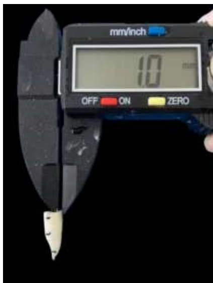
Figura 13: Amostras com espessura interna em todas as faces de 1mm.
