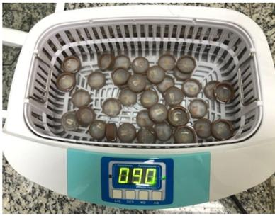
Figura 18 - Ciclo de lavagem em cuba ultrassônica
