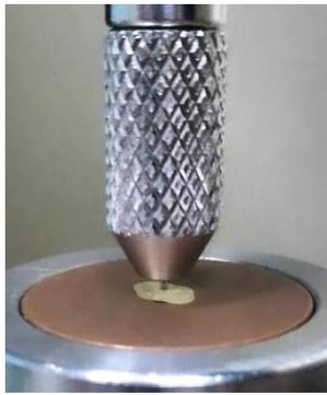
Figura 26 - teste de push out
