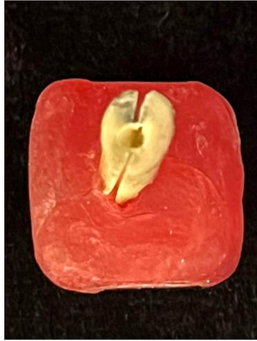
*Figura 1 - Amostra com os sulcos e inserida em cera*
