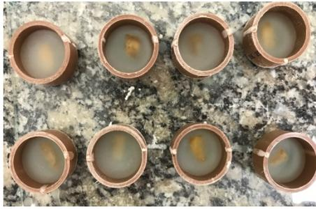
*Figura 15 - Amostras fixadas em resina acrílica*
