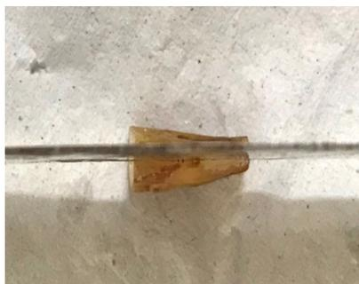
*Figura 13 - Lâmina de micrótomo*
