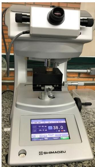
Figura 20 - Microdurometro vickers
