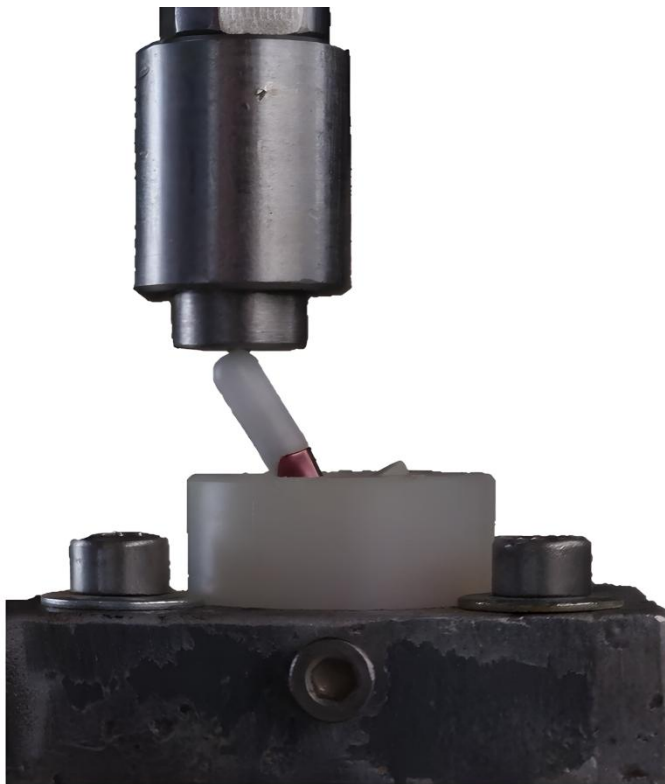
Figura 8. Configuração de teste de fadiga conforme as instruções da ISO 14801:2016. Na imagem, o pilar referência (PAR) está recebendo a carga através da transmissão de forças do pistão de metal para o coping hemisférico de zircônia.
