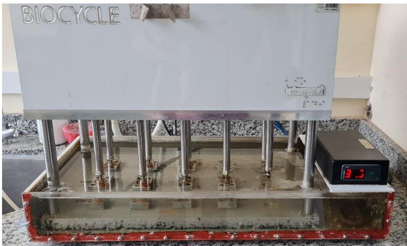
**Figura 4:** Amostras acomodadas na cicladora pneumática.
