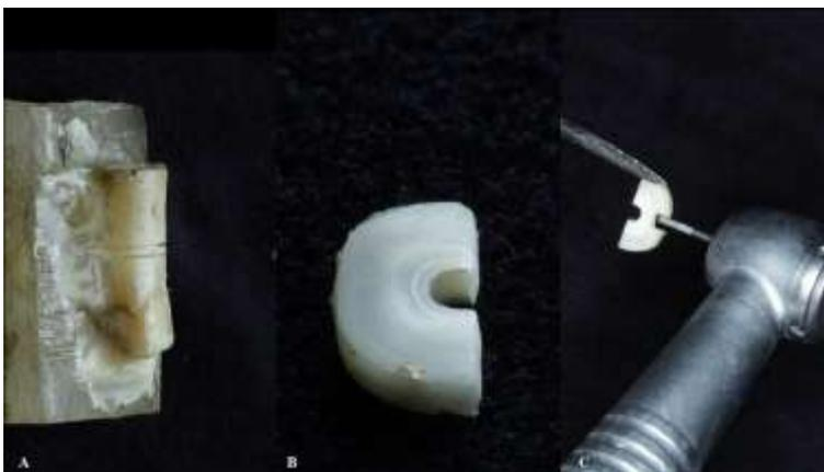
Figura 10. Confecção das amostras em formato de ampulheta. A: Cortes perpendiculares ao longo eixo do dente. B: Espécimes da porção radicular. C: Desgaste com broca para obtenção da ampulheta. Fonte: Arquivo pessoal.
