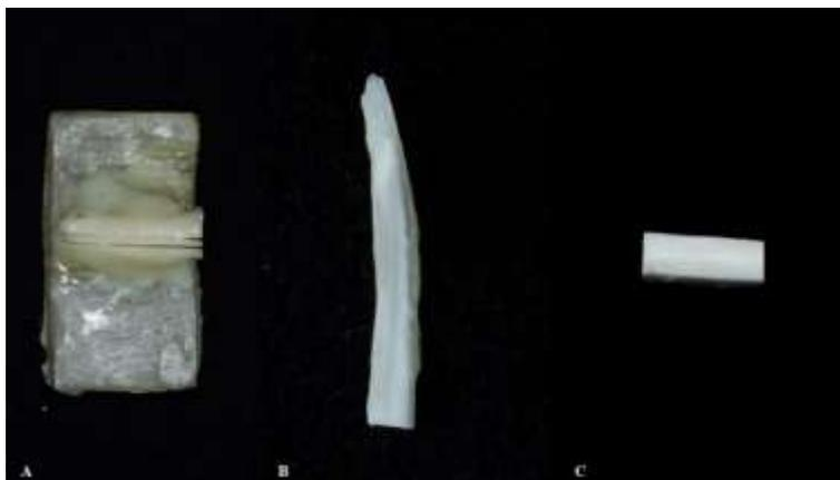
Figura 8. Obtenção dos palitos de dentina. A: Cortes para obtenção de fragmentos de dentina. B: Fragmento de dentina. C: Amostra em forma de palito utilizada para o teste. Fonte: Arquivo pessoal.
