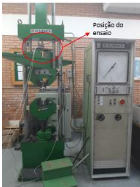
Figura 41: Ensaio estático em Mandíbula Grupo II. Fonte: Autoria própria (2021).
