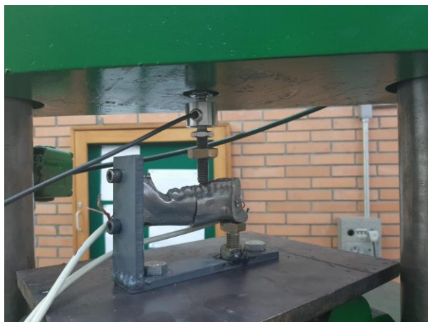
Figura 42: Ensaio estático em Mandíbula Grupo I.
