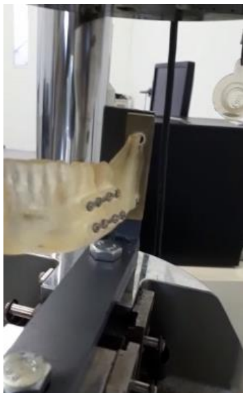
Figura 31: Ensaio de fadiga em corpo de prova constituinte do estudo piloto.
