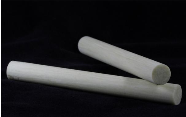
*Figura 3 – Barras circulares de CRFV com  $\approx 12.7$ mm de diâmetro.*
