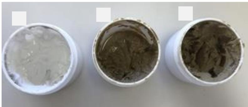
*Figura 50: Aspecto físico das pastas experimentais F1, F2 e F3 respectivamente após 30 dias.*
