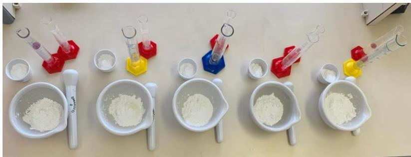
*Figura 3: Componentes proporcionados (pó e líquido) para cada formulação de pasta*
