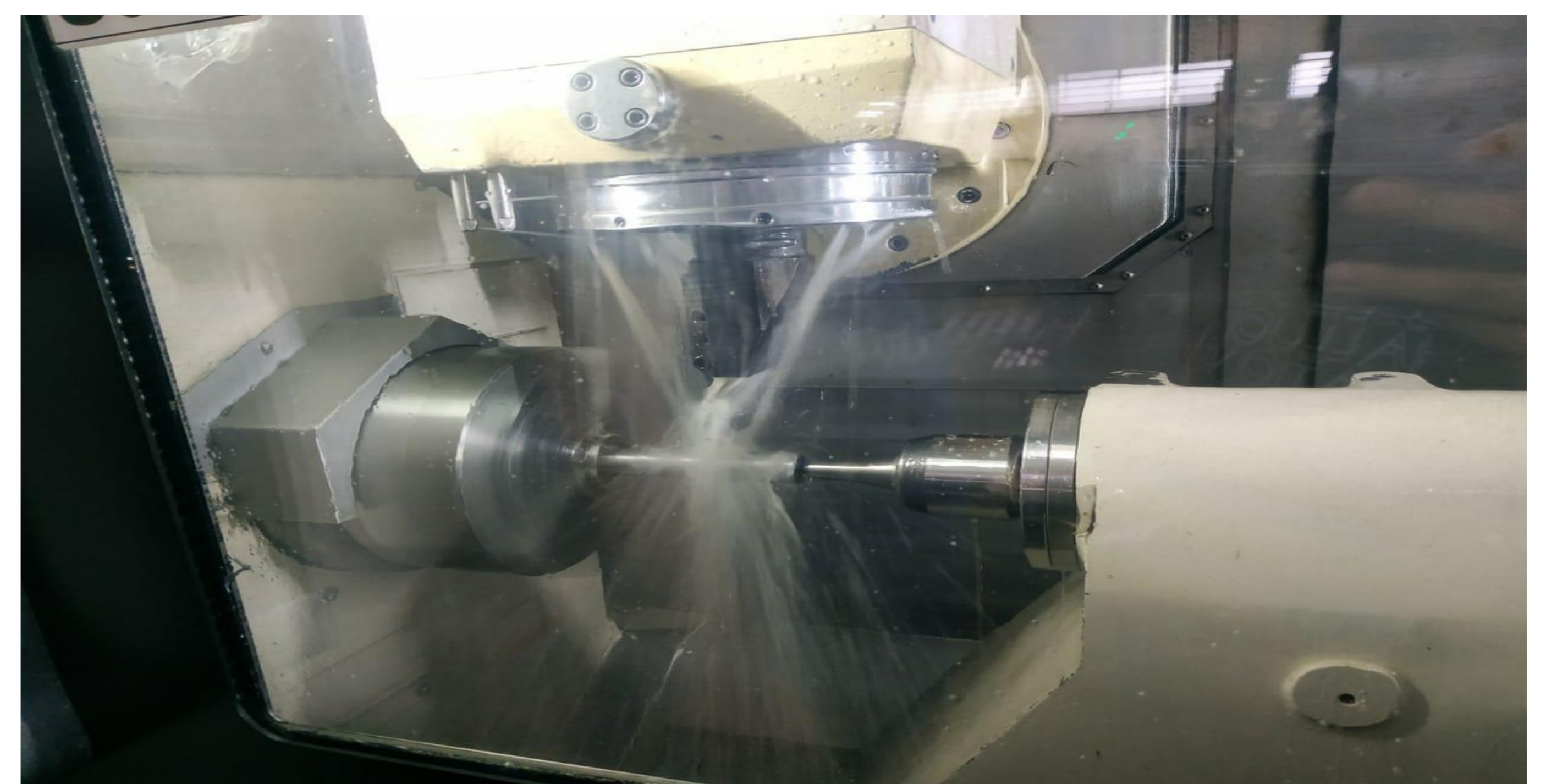
Figura 1: Processo de usinagem do Eixo, no Integrex J-200.
