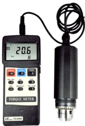
Figura 2 – Torquímetro Digital Portátil Lutron TQ – 8800 utilizado no estudo.
