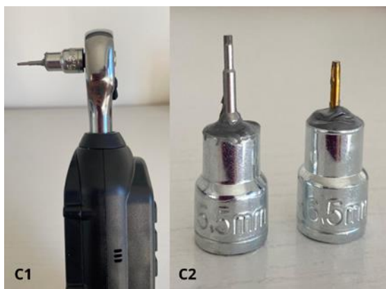
Figura 5 - Soquete sextavado adaptado ao torquímetro com a chave digital.
