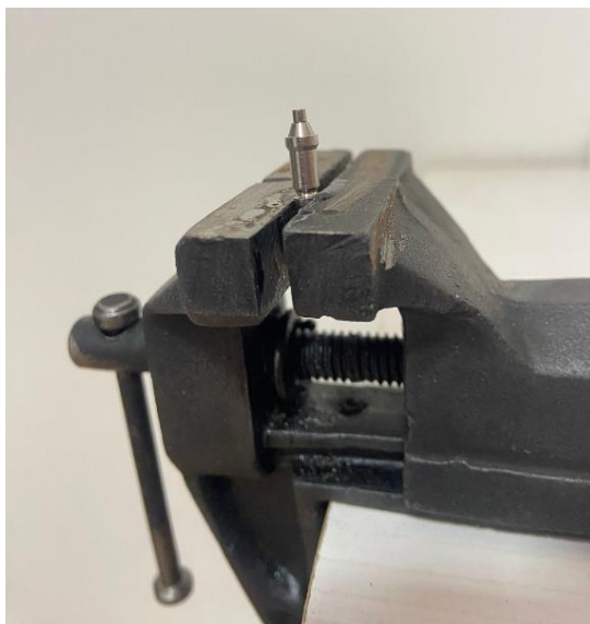
Figura 8 - Análogo com parafuso firmado pela mini morsa.
