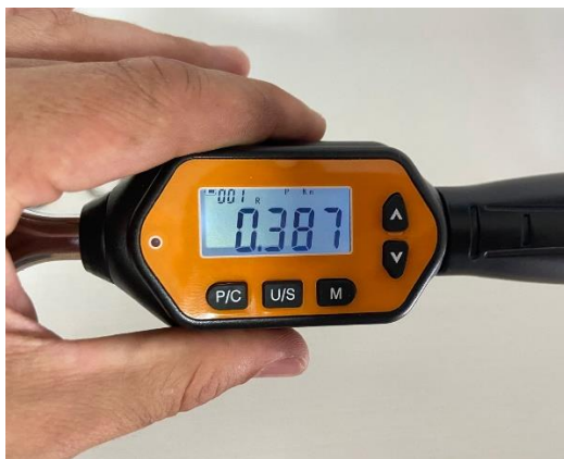
Figura 10 - Visor do torquímetro digital indicando o valor do torque em N/m no momento da fratura do parafuso.
