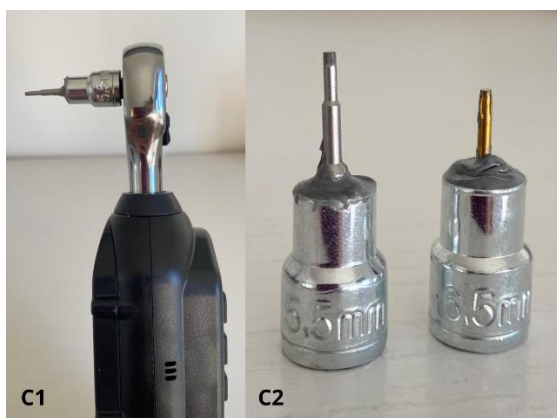
Figura 9 - Soquete sextavado adaptado ao torquímetro com a chave digital.
