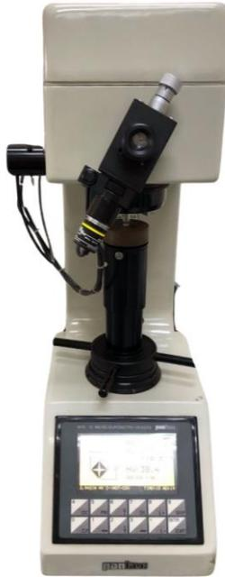
*Figura 5 - Microdurômetro (HSV-10, Pantec).*
