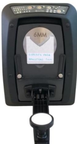
*Figura 11 - Corpo de prova posicionado sobre a abertura de medição do espectrofotômetro.*
