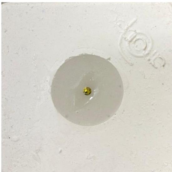
Figura 3: Amostras sendo colocadas na resina acrílica.
