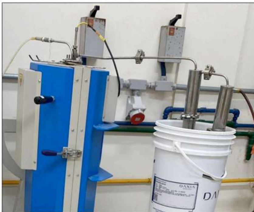
Figura 6 - Registro fotográfico do reator de pirólise, incluindo a mufla com um tubo interno acoplado com a entrada de gases inertes e saída para os dois cilindros inox em série
