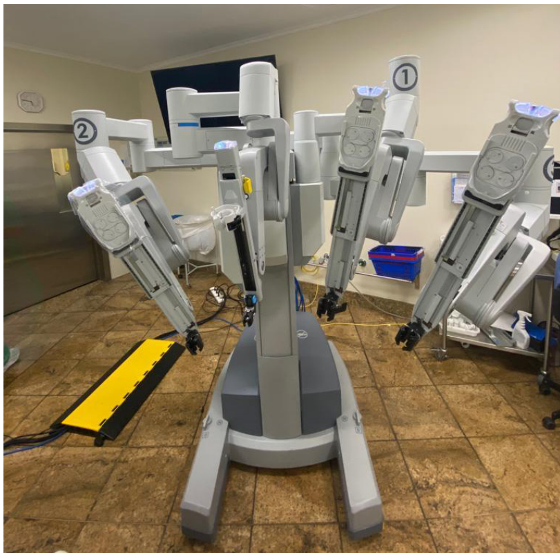
Figura 5 – Carrinho do paciente: visualização dos braços do robô (modelo Da Vinci Si)
