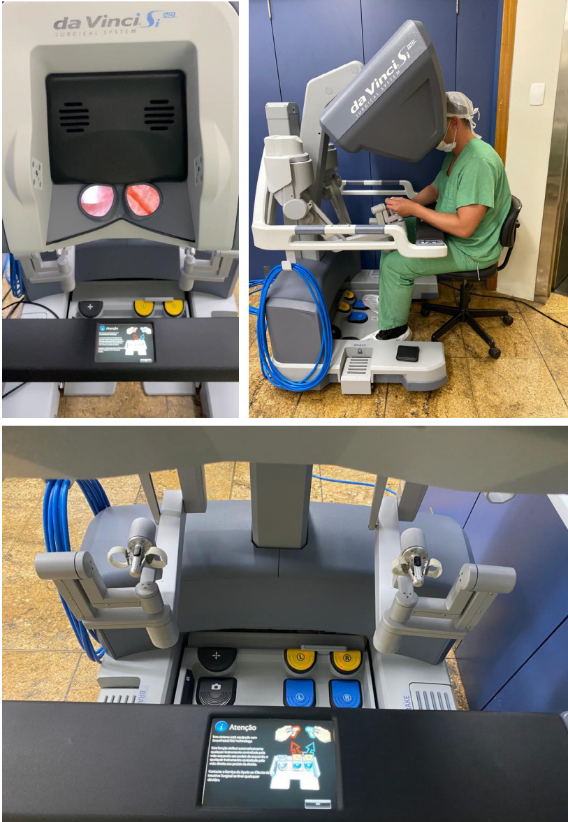
Figura 4 – Console do cirurgião
